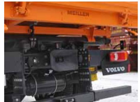
Zwei Anhängerkupplungen: die Maulkupplung für große Zentralachser, die kleine Kugelkopfkupplung für 3,5-Tonner
