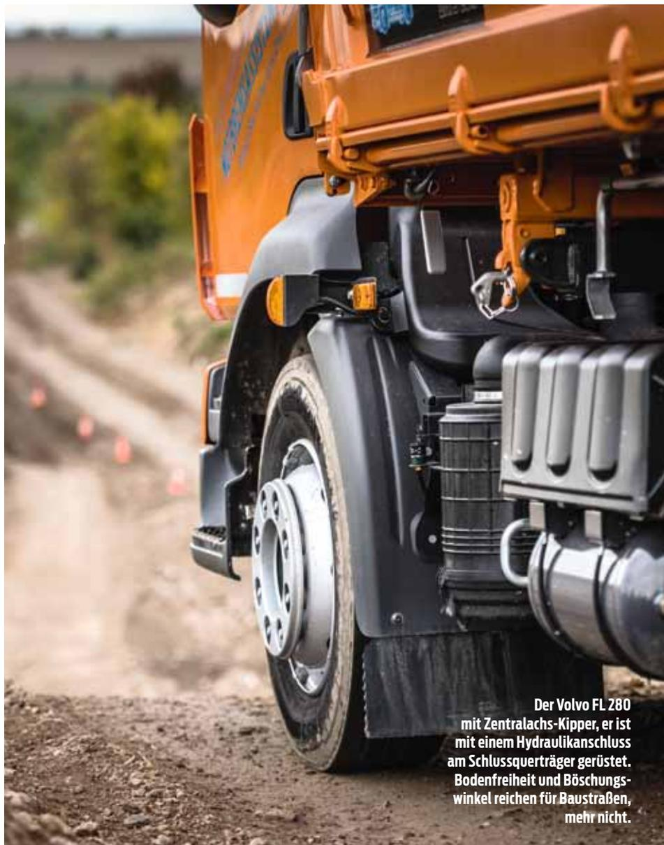
Der Volvo FL 280 mit Zentralachs-Kipper, er ist mit einem Hydraulikanschluss am Schlussquerträger gerüstet. Bodenfremheit und Böschungswinkel reichen für Baustraßen, mehr nicht.
