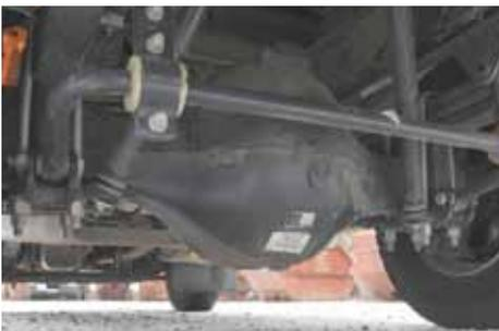
Blick unter den Rahmen: Wenig Bodenfreiheit unter der Differenzialglocke, auch der Stabilisator sitzt tief.
