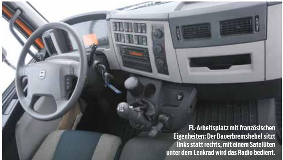
**FL-Arbeitsplatz mit französischen Eigenheiten: Der Dauerbremshebel sitzt links statt rechts, mit einem Satelliten unter dem Lenkrad wird das Radio bedient.**
