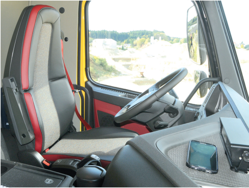
Knappe Platzverhältnisse in der FMX-Kabine: prima Ergonomie, aber kein Umstieg zur Beifahrerseite
