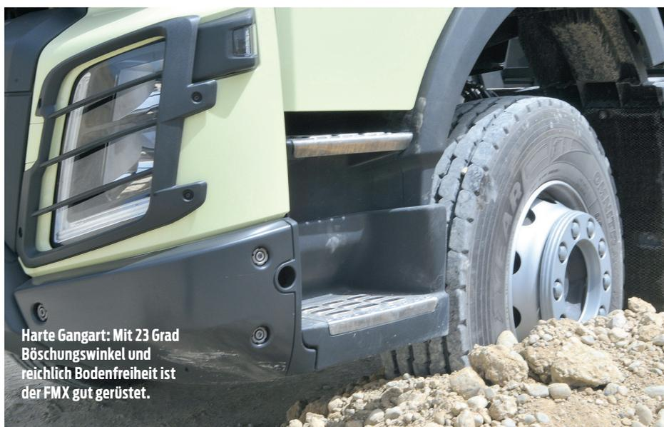
**Harte Gangart:** Mit 23 Grad Böschungswinkel und reichlich Bodenfreiheit ist der FMX gut gerüstet.
