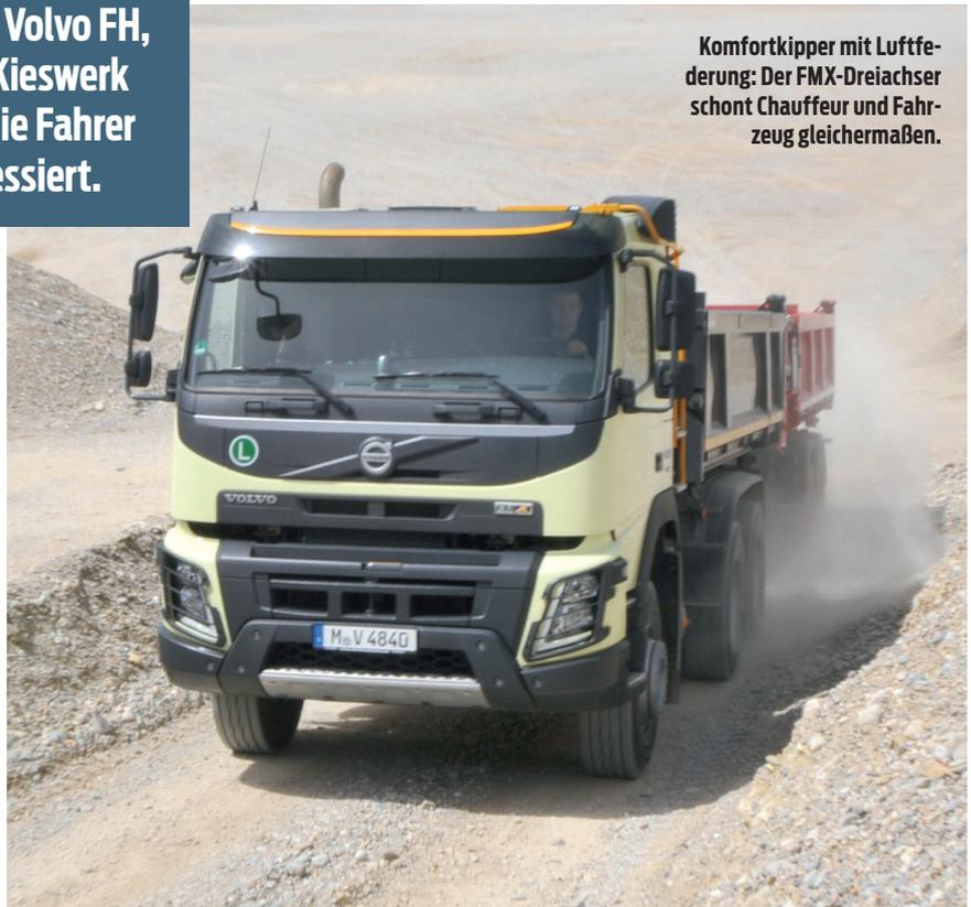
**Komfortkipper mit Luftfederung: Der FMX-Dreischser schont Chauffeur und Fahrzeug gleichermaßen.**
