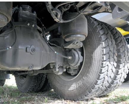
**Sorgfältig konstruiert: Federbälge, Stabilisatoren und Bremszylinder sitzen sicher im Radschatten.**
