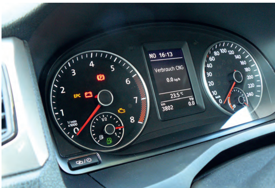
Gleich zwei Tankanzeigen informieren über den Stand der Dinge, das grüne Signet steht für den Gasvorrat.
