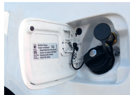
Der Einfüllstutzen für Benzin und der Anschluss fürs Gas sind beide hinter der gewohnten Tankklappe angesiedelt.
