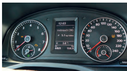
Kleine Veränderung bei den Instrumenten: Füllstandsanzeigen für Gas (links) und Benzin (rechts).
