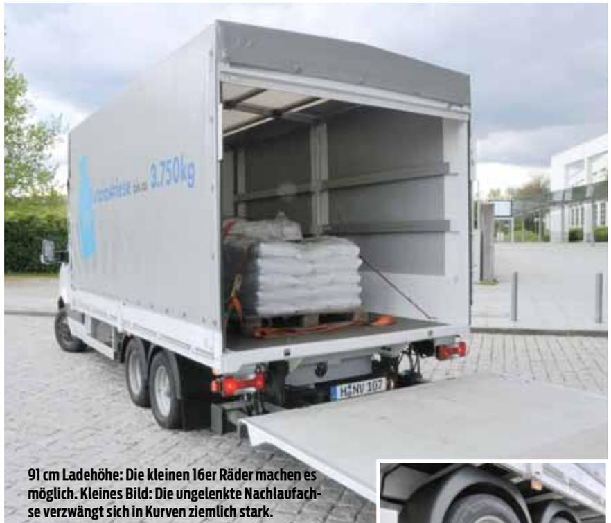
**91 cm Ladehöhe: Die kleinen 16er Räder machen es möglich. Kleines Bild: Die un gelenkte Nachlaufachse verzängt sich in Kurven ziemlich stark.**
