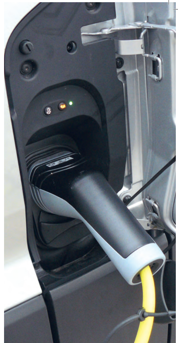
„Getankt“ wird an gewohnter Stelle mit Typ-2- und Combo-2-Stecker. Damit ist der E-Crafter schnellladefähig.
