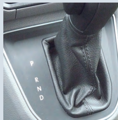
P-R-N-D: Wählhebel für die Fahrtrichtung wie bei einem Automatikgetriebe
