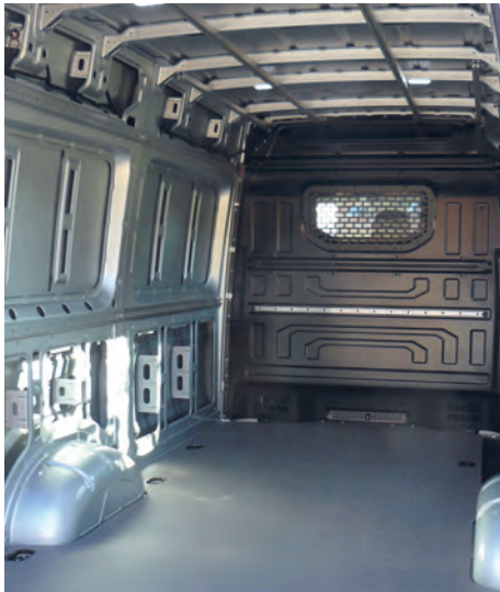
Antrieb auf die Vorderräder plus höherer Ladeboden vom Heckantrieb gleich Platz für Batterien im Untergrund.
