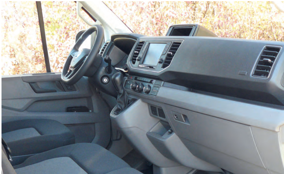
Sieht aus wie immer, ist grau, aber nicht grülich: viel Platz, bequeme Sitze und jede Menge Ablagen im Cockpit. Rechts: Powermeter statt Drehzahlmesser und weitere Spezialitäten wie eine Anzeige der zur Verfügung stehenden Leistung. Der Bildschirm informiert großflächig über die zur Verfügung stehende Reichweite, über den Energiefluss und die Rekuperation. Je nach Strecke und Fahrstil kommen in wenigen Minuten einige 100 Wattstunden zusammen.
