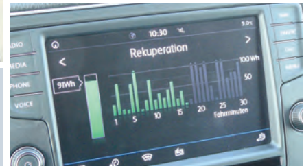
Sieht aus wie immer, ist grau, aber nicht grülich: viel Platz, bequeme Sitze und jede Menge Ablagen im Cockpit. Rechts: Powermeter statt Drehzahlmesser und weitere Spezialitäten wie eine Anzeige der zur Verfügung stehenden Leistung. Der Bildschirm informiert großflächig über die zur Verfügung stehende Reichweite, über den Energiefluss und die Rekuperation. Je nach Strecke und Fahrstil kommen in wenigen Minuten einige 100 Wattstunden zusammen.
