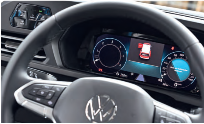
Daran kann man sich gewöhnen: optional digitale und konfigurierbare Instrumente, Tastenfläche links für alles rund um Licht und Sicht.
