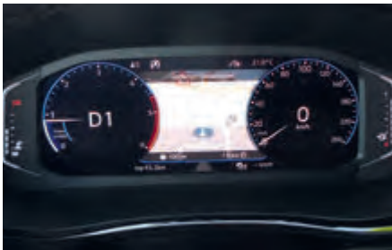
Digi-Instrumente Teil eins: klassische Aufteilung mit großen Rundinstrumenten, aber frei konfigurierbarem Mittelfeld.
