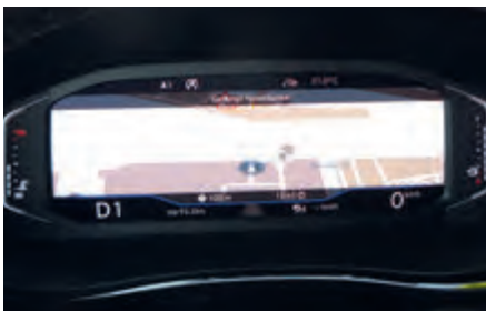
Digi-Instrumente Teil3: maximales Kartenbild, sekundäre Anzeigen sind in den Hintergrund gedrängt.
