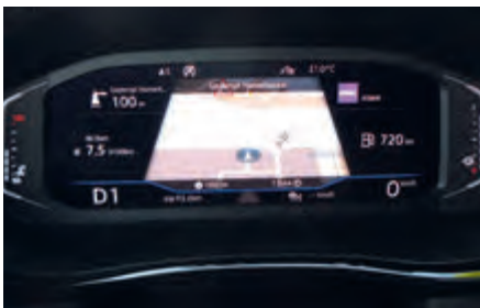
Digi-Instrumente Teil zwei: Nun vergrößert sich die Navi-Karte, kein Drehzahlmesser, Tacho mit Digitalanzeige.
