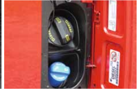
Von links: Der Transporter glänzt mit Ablagen, zum Beispiel in der geräumigen Sitztruhe unter dem Doppelsitz. Werkzeug und Verbandtasche hinten links im Laderaum – wie wär's mit einem Platz im Fahrerhaus, etwa in der Sitztruhe? Mit dem Schritt zu EU 6 bekommt der T6 SCR-Technik mit Adblue-Einspritzung.
