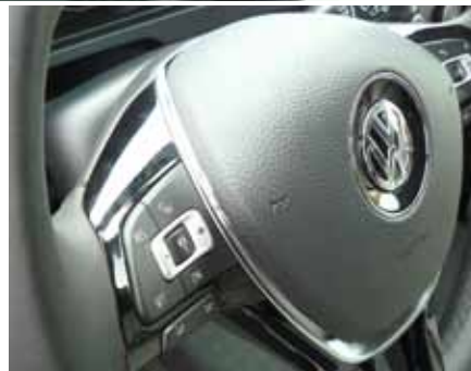
Kleine, aber inhaltlich schlüssige Lenkradtasten, zum Beispiel zur Bedienung des Abstandsregeltempomaten
