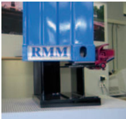
**RMM-Containerverriegelung für Waggons offen ... und geschlossen**
