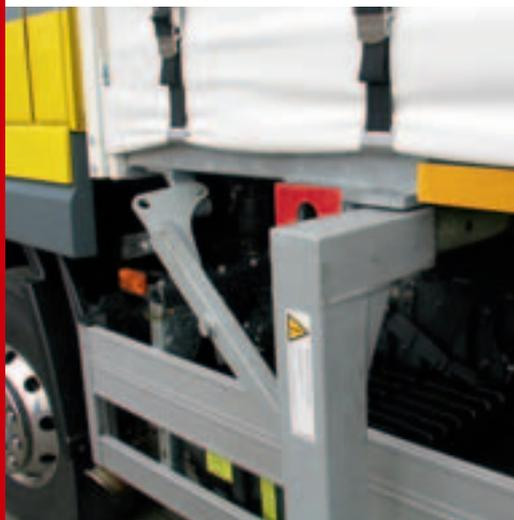
Stütze und Strebe in äußerer Position
